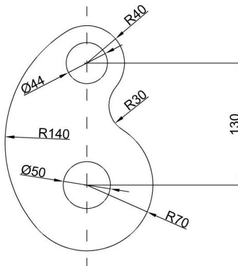
2. Dada la siguiente figura dibujar las tres vistas de sus proyecciones diédricas en el Sistema Europeo (2 puntos). Se tomarán las mismas medidas que en el modelo sin tener en cuenta coeficientes de reducción. Acotar las vistas obtenidas (2 puntos)
